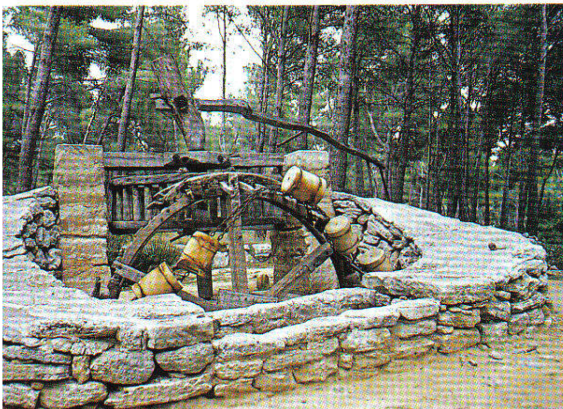
Obr. 1.45 Stará noria na ostrove Malorca v Stredozemnom mori. Gepel' bol poháňaný somárom. Fungoval ako čerpadlo na vodu ešte od Rímskych čias [21]
