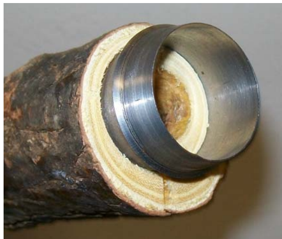
Obr. 3.18 Originálny kovový prstenec na vodotesné spájanie rúr (foto autor Múzeum ľudovej architektúry Bardejovské Kúpele), a upevnenie vyrobeného v kmeni
