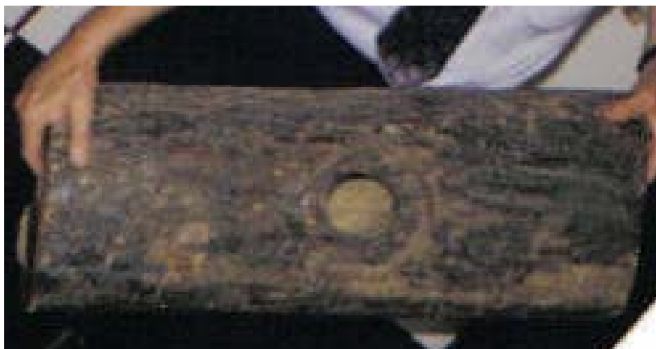
Obr. 3. 19 Krátka rúra s bočným osadením na nasadenie zvislej rúry
