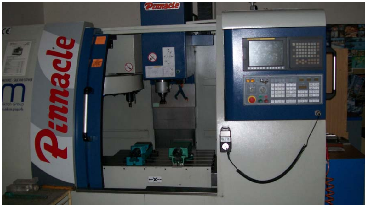
Obr. 3.72 Súčasná NC frézka a sústruh (riadiaci systém je súčasťou stroja)
