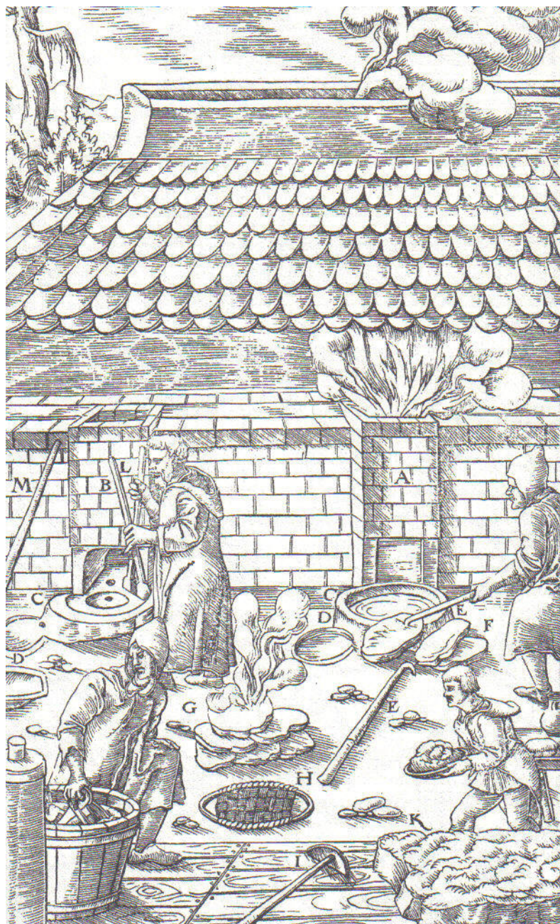
Obr. 2.30 Práca tavičov podľa AGRICOLU. A,B – pece, C-horné predpecie, D-dolné predpecie. Hutník sťahuje trosku F zahnutou tyčou E. G-Pomocník hasí žeravú trosku zalievaním. H-pletená ošatka z prútia, I-hrabačka, K-ruda na tavenie. Pri peci B majster pripravuje predpecie, ubíja ubijadlami L. M-tyč
