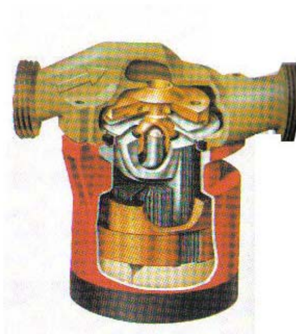
Obr. 1.236 Laingov elektromotor. Rotor je súčasne obežným kolesom čerpadla.
