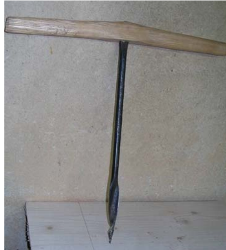
Obr. 3.39 Kolovrátok, alebo „prsná vrtačka“, ručný vrtáčik na malé dierky do dreva, „svidrik“ a vratidlový vrták „nebožiec“
