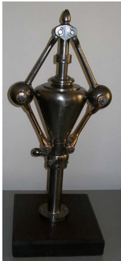
Obr. 1.114 Wattov odstredivý regulátor prívodu pary (Slovenské technické múzeum Košice) a jeho funkcia, vľavo
