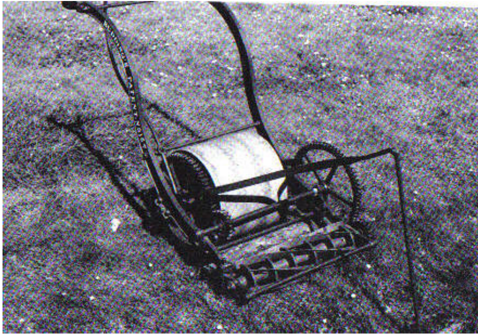
Obr. 4.27 Britský stroj na kosenie trávy. Zariadenie ťahal kôň, alebo vól a roľník viedol kosačku za rukoväte. Nožové koleso poháňal prevodom valec (vpredu)
