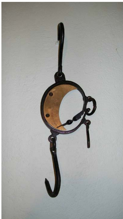
Obr. 5.3 Mincier z autorovej zbierky. Používal sa v mlynoch na váženie vriec obilia a múky. Pri tomto upevnení meria do 200 kg. Z opačnej strany je stupnica do 22 kg. Náklad je však uchytенý na háky na konci pružného rámu. Po únave pružiny sa nulová poloha kalibrovala ohnutím kovovej ručičky
