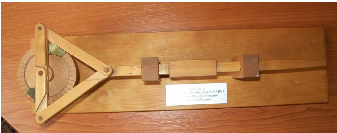
Obr. 1.157 Model pákového paralelogramového prevodu lineárneho pohybu na rotačný.
