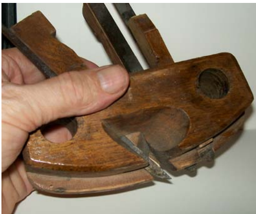
Obr. 2.20 Rímsky hoblík (1) a súprava novších hoblíkov na výrobu sudov (zbierka autora)., 2 - drážkovací hoblík na drážky suda, 3 - nastavovací drážkovací hoblík
