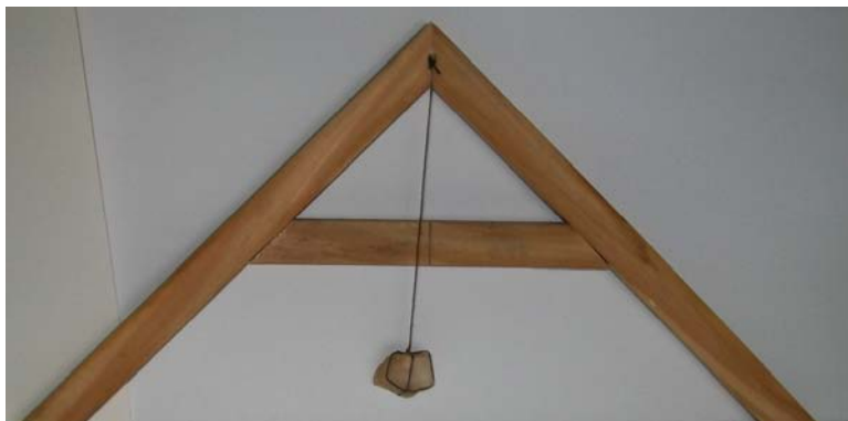
Obr. 1.27 Prístroj na kontrolu vodorovnej polohy kvádrov pri stavbe pyramíd (krokvica)
