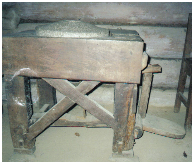
Obr. 4.21 Kamenné mlynčeky, ovládaný ručne a šľapací
