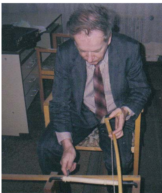
Obr. 3.14 Brúsenie na lukovom sústruhu (dobová rytina) a autorov pokus o sústruženie drevenej pišťalky (tentoraz už s opierkou)
