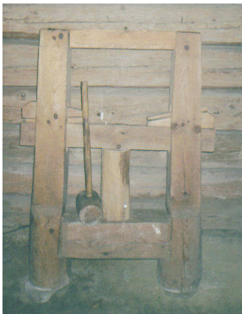
Obr. 4.24 Drevený lis (kyjanicou sa z oboch strán vbíjajú klíny, ktoré tlačia cez priečnik na piest)
