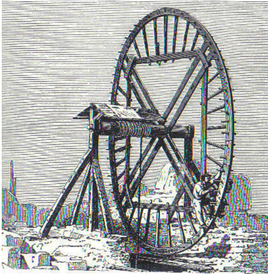
Obr. 1.19 Rekonštrukcia starého šliapacieho kolesa z Mezopotámie. Po obvode sú kolíčky, po ktorých šliapal človek [21]
