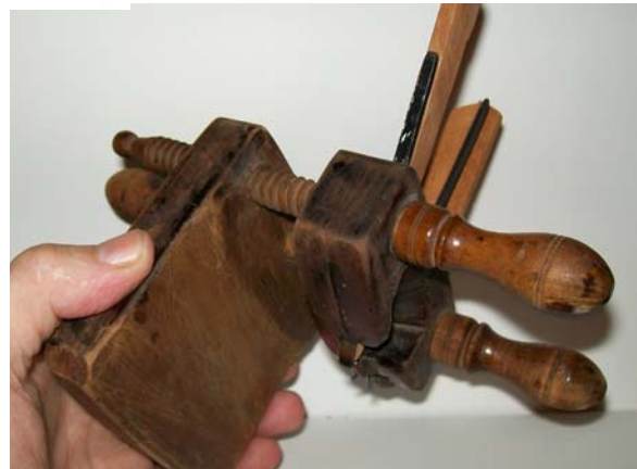
Obr. 2.20 Rímsky hoblík (1) a súprava novších hoblíkov na výrobu sudov (zbierka autora)., 2 - drážkovací hoblík na drážky suda, 3 - nastavovací drážkovací hoblík
