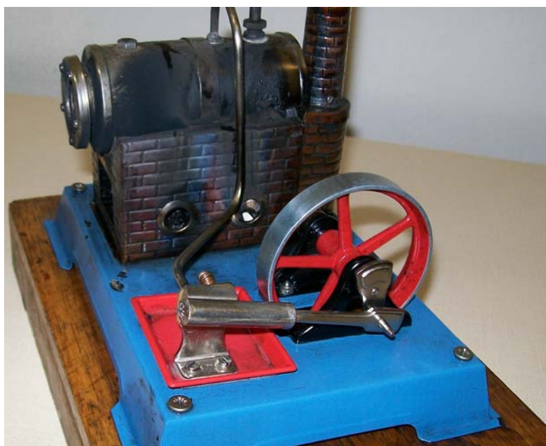
Obr. 1.122 Funkčný model funkčného jednočinného parného stroja z autorovej zbierky
