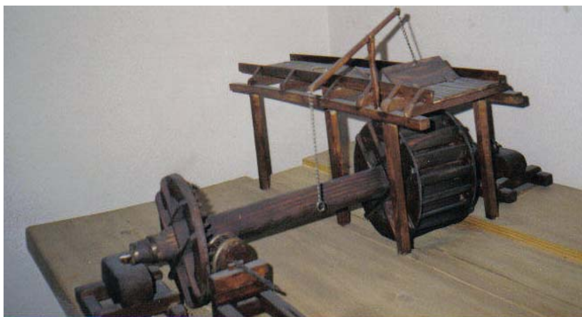
Obr. 3.21 Zariadenie na vrtanie rúr (Múzeum ľudovej architektúry Bardejovské Kúpele) a jeho autorov zmenšený model (dole). 1-vodné koleso, 2-ozubená koleso, 3-pastorok (prevod 1:3), 4-vrták, 5-sane
