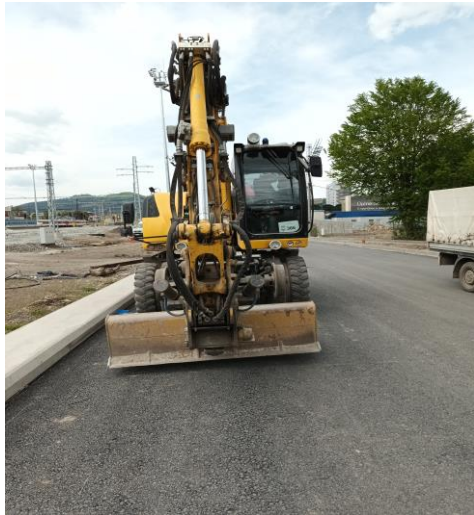
Otočný bager je hybridný môže ísť po koľajniciach aj po zemi.
