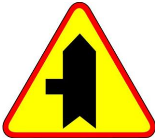
Znak A-6c Skrzyżowanie z drogą podporządkowaną występującą po lewej stronie
